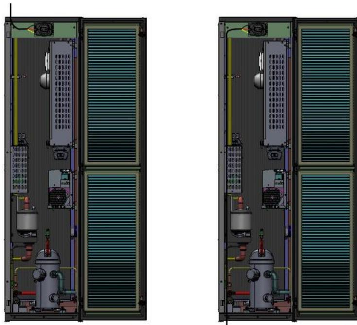
As unidades CR também necessitam de um cabo de alimentação. A ligação também é feita diretamente na chave geral do equipamento, conforme ilustrações a seguir:
