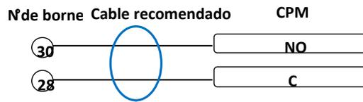
Cable de instrumentación 2 x 0,5 mm<sup>2</sup> BLFA BIC con blindaje colectivo y por par según NBR10300
