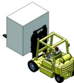
En algunos casos no es posible hacer uso de la apiladora, porque el local de instalación es inaccesible, siendo necesaria, por lo tanto, la utilización de un camión munck o izado con grúa.
