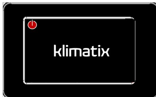
Para encender el equipo, después de energizar el panel de comando, en la IHM PGD1 (montaje estándar) se debe presionar los botones ↑ y ↓ para que sea exhibida la pantalla de accionamiento de la unidad CP. Ya en la IHM PGDX (montaje opcional) el botón para accionamiento de la unidad CP se encuentra en la esquina superior izquierda, de acuerdo con las indicaciones abajo:
